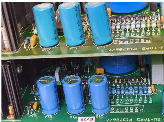
3-1. ábra A felső modul kondenzátorainak elektrolitja szivárog: színük világosabb, mint az alsó modulon levőknek, és a körülöttük levő NyÁK-lap felület is elszíneződött
