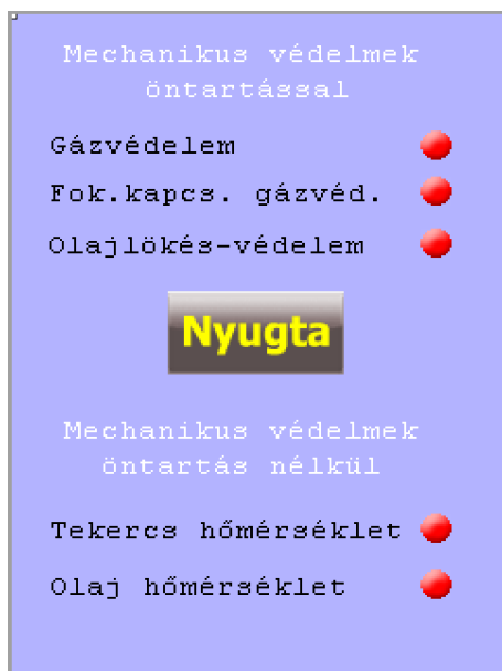
2-2. Ábra – A Mechanikai védelem oldal
