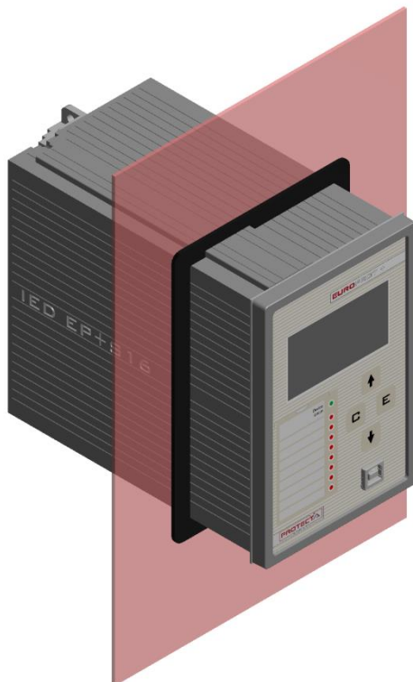
3-8. ábra – S16 méretezés félig süllyesztett kivitelben (max. mélység = 75 mm)
