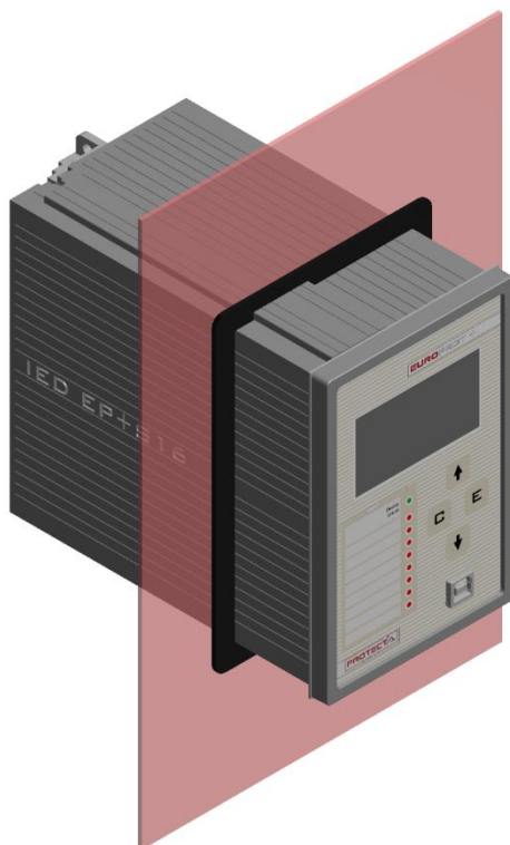
4-3. ábra – S16 méretezés félig süllyesztett kivitelben (max. mélység = 75 mm)
