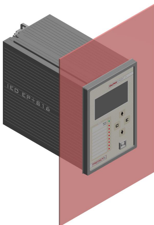
4-4. ábra – S16 ajtó kivágásba szerelhető kivitelben
