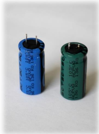
Figure 4-1 Condensatorul din dreapta este decolorat
